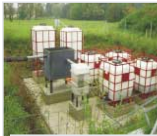
Rys. 8. Zestaw pomiarowo-badawczy (sampling system) z urządzeniem EcoDrain™ (z plexi).
