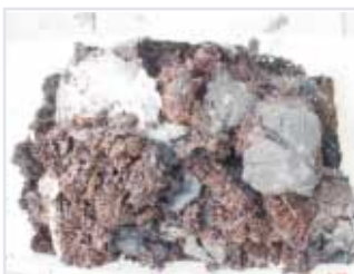
Rys. 3. Zużyte i przetworzone (po 3 miesiącach) złożo Aikaterisil™
