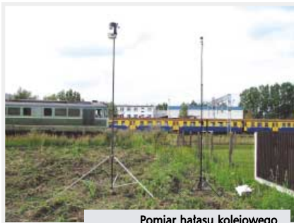
Pomiar hałasu kolejowego – mikrofon i stacja meteo
