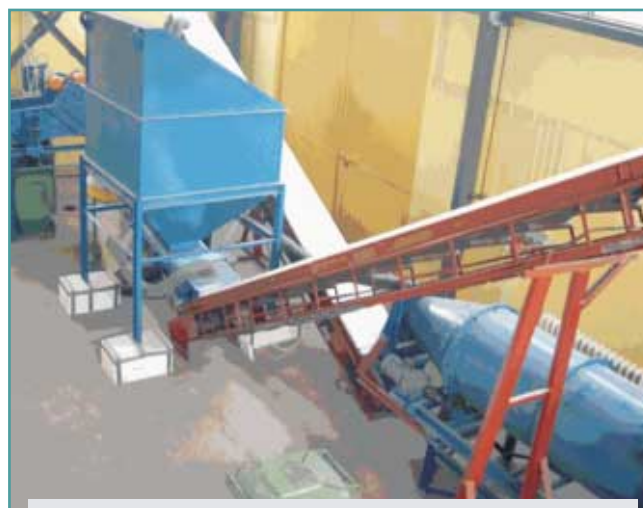
Widok linii przerobu szkła stożków – kosz, przenośnik taśmowy, kruszarka, ocieracz
