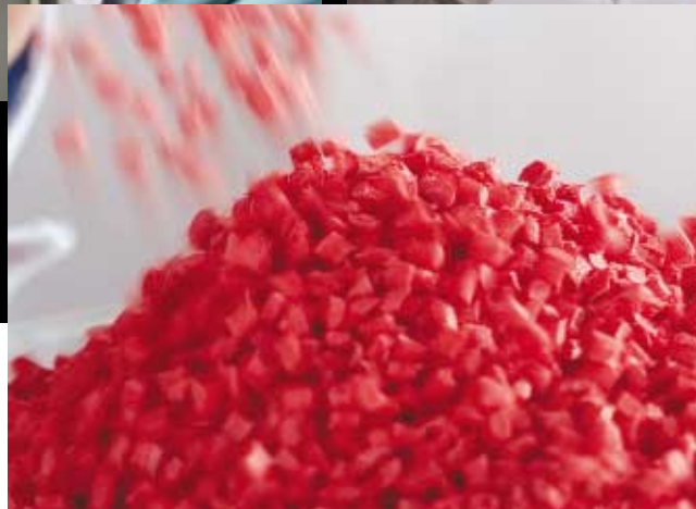
Obok: Ultradur @ High Speed: dzięki wprowadzeniu specjalnych nanocząsteczek udało się wyraźnie zwiększyć m.in. odporność na starzenie termiczne. Materiał wyjściowy do produkcji elementów z tworzyw sztucznych. Foto: BASF The Chemical Company, 2007
