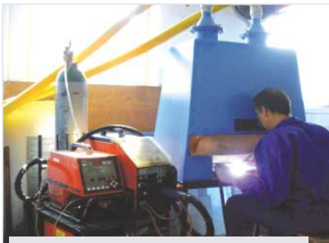
Fot. 3. Stanowisko doświadczalne do badań emisji zanieczyszczeń przy spawaniu łukowym elektrodą nietopliwą – metoda TIG
