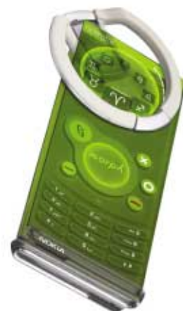
Nokia Morph - telefon przyszłości: Użytkownik może mu nadawać różne kształty, dopasowane do aktualnie wybieranej funkcji (np. rozciągnąć na boki). Cała powierzchnia to jeden wielki panel słoneczny. Nanotechnologia zapewnia samoczyszczące się powierzchnie, plastyczność oraz przezroczystą elektronikę. Fot. Nokia
