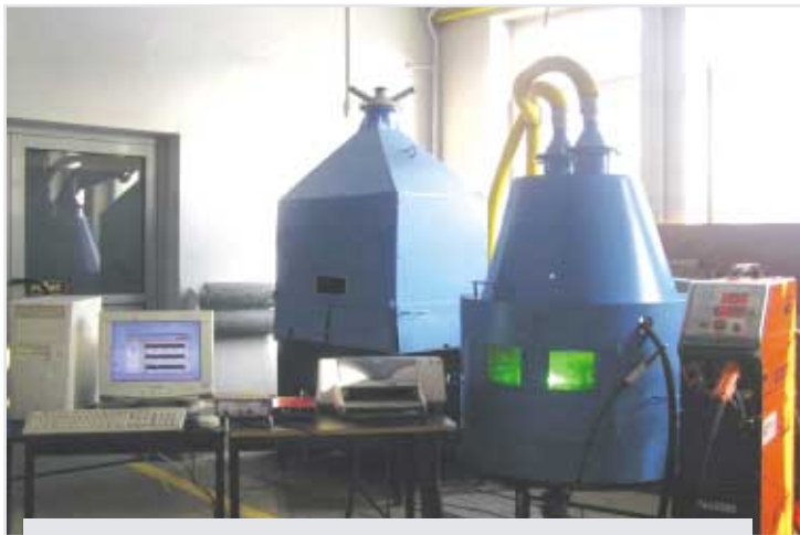
Fot. 1. Stanowisko doświadczalne do badań emisji zanieczyszczeń przy spawaniu łukowym w osłonie gazów – metoda MIG/MAG
