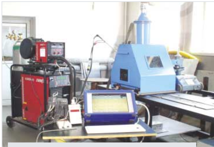
Fot. 2. Stanowisko doświadczalne do badań emisji zanieczyszczeń przy niskoenergetycznym spawaniu łukowym materiałów wrażliwych na ciepło
