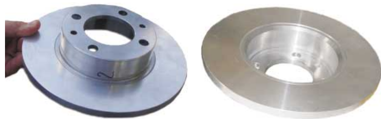
Fotografia prototypowej tarczy hamulcowej wykonanej z kompozytu ALFA (widok z obu stron) do krajowego samochodu osobowego marki Polonez
