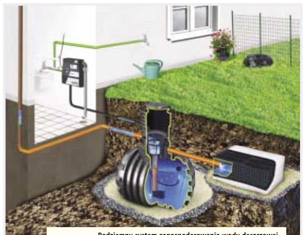
Podziemny system zagospodarowania wody deszczowej
