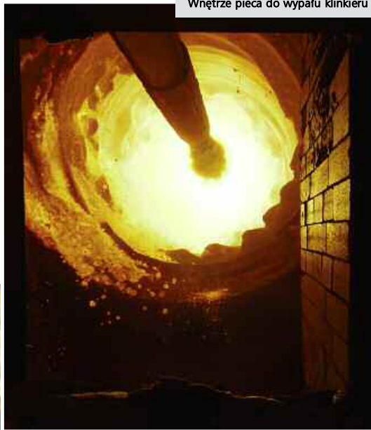
Wnętrze pieca do wypалу klinkieru
