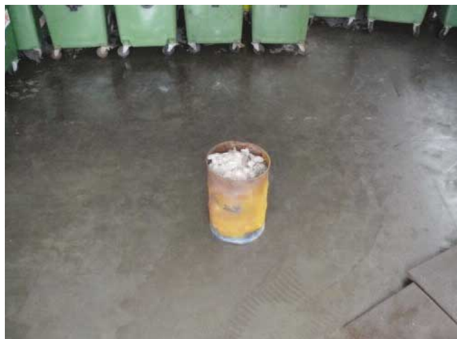
Porównanie objętości odpadu medycznego do objętości odpadu po termicznym przekształceniu odpadów medycznych (redukcja ok. 98%)
