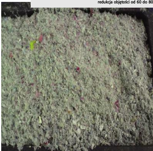
Zdjęcie 1 i 2. Porównanie stanu fizycznego wsadu – odpadów medycznych do odpadów wtórnych (redukcja masy o ok. 30%, redukcja objętości od 60 do 80%)
