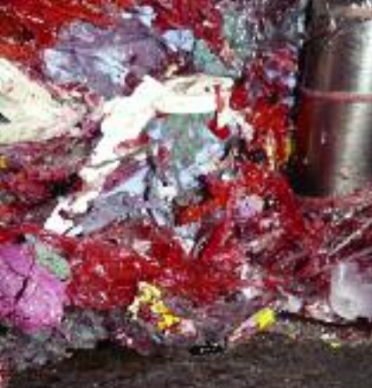
Odpad medyczny po rozdrobnieniu przed procesem wysokotemperaturowego unieszkodliwiania odpadów
