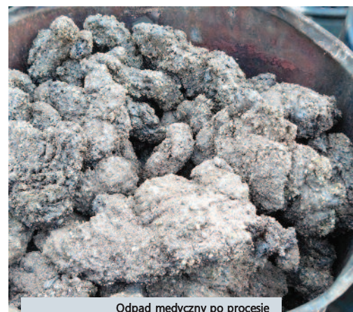
Odpad medyczny po procesie wysokotemperaturowego (1100 stopni C) unieszkodliwienia – 10% masy odpadów medycznych
